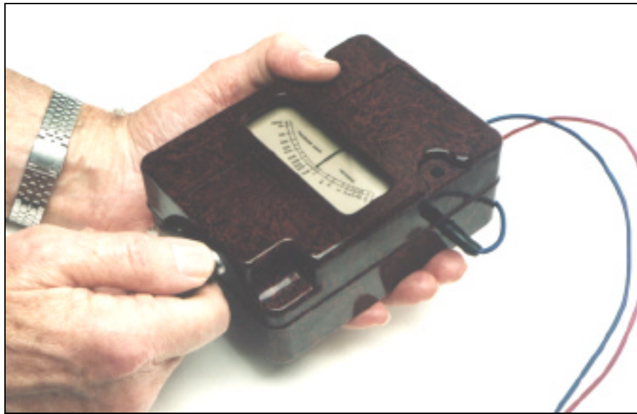
Fig. 5.06 - The Wee Megger Tester
